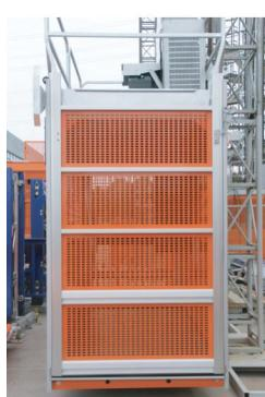
2. Укороченная дверь с рампой повышает эффективность эксплуатации
